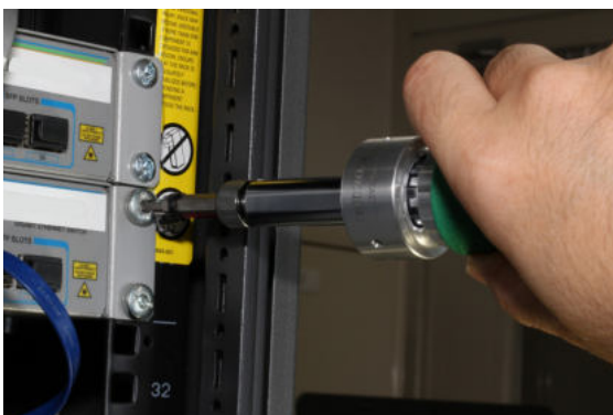
Anwendungsbeispiel Linsenkopfschraube Application example binding head screw
