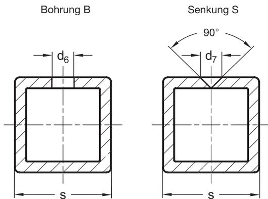
Die Vierkante der Rastschlitten sind auf Konstruktionsrohre GN 990 abgestimmt. Diese können vom Anwender gemäß den in der Tabelle angegebenen Maßen mit Rastbohrungen (B oder S) versehen werden.
