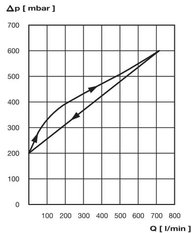
Druckverlauf  $\Delta p$  [mbar] im Behälter in Abhängigkeit vom Luftdurchsatz [l/min.] bei Ventilöffnungsdruck 350 mbar (Ausführung mit Filter und Doppelventil).
