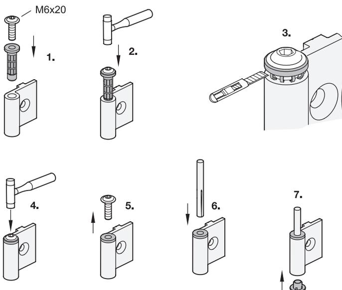
1. Die Lagerbuchse in der gewünschten Einbau- richtung auf dem Scharnierflügel positionieren. Anschließend eine Schraube mit Bund wie z. B. Linsenschrauben ISO 7380 in die Lagerbuchse stecken um den Bund der Lagerbuchse beim Einschlagen vor Beschädigungen zu schützen.
