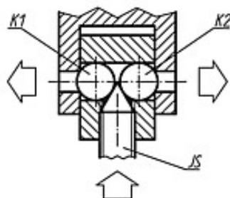
Durch Drehen der Justierschraube (JS) werden die beiden Kugeln K1 und K2 auseinander bewegt und gegen die Wandung gedrückt. Dadurch ist eine spielfreie Justierung möglich.
