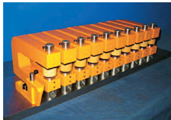
Locheinheiten durch eine Positionsplatte eingerichtet
