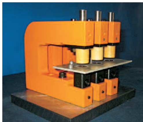
Locheinheiten durch eine Schablone positioniert
