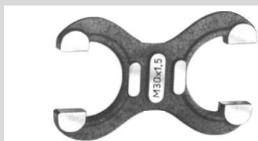
Grenzrachenlehre Nr. 122 A für den Außendurchmesser des Bolzengehwindes
