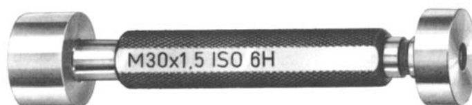
Grenzlehrdorn Nr. 101 K für den Kerndurchmesser des Muttergehwindes
