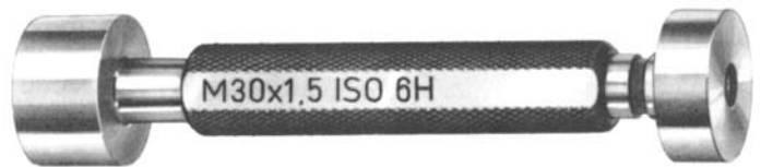
Grenzlehrdorn Nr. 101 K für den Kerndurchmesser des Mutterge- windes
