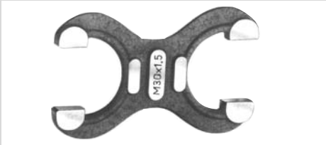
Grenzrachenlehre Nr. 122 A für den Außendurchmesser des Bolzen- gewindes
