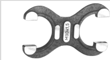
Grenzrachenlehre Nr. 122 A für den Außendurchmesser des Bolzengewindes
