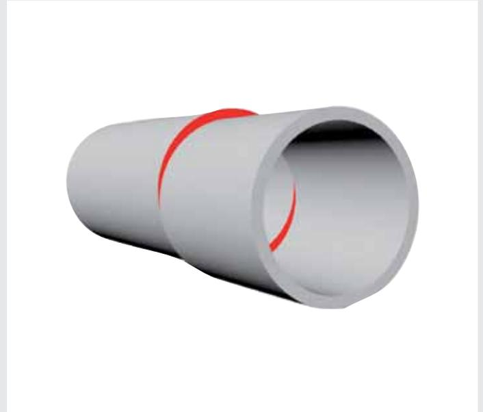
Verbindung von Rohren mit Achsversatz
