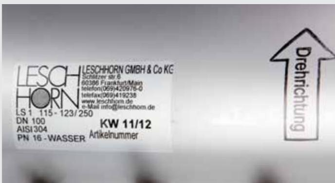
Die LS 1-H Schelle mit zwei Haltegriffen ist zudem mit dem Herstellungsdatum KW/Jahr und einem Aufdruck über die Drehrichtung versehen.
