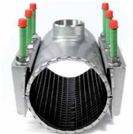
Hochdruckschelle bis 25 bar. Abkantung verhindert Verschiebung der Gummidichtung unter starkem Druck
