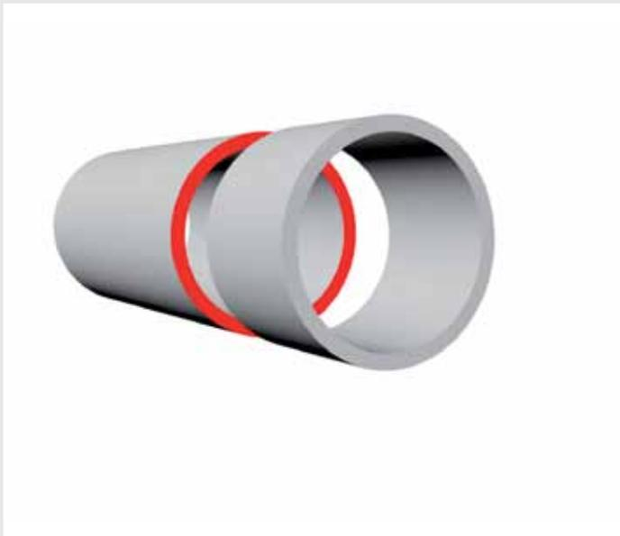
Verbindung von Rohren mit Rohr-endenabstand
