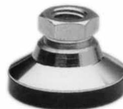
Für höhere Beanspruchungen können GelenkfüÙe mit handelsüblichen Schrauben höherer Fertigkeitsklasse kombiniert werden. Vorzugsweise sind Gewindestifte DIN 915 mit Druckzapfen zu verwenden. Dabei muß der Zapfen auf dem Bohrungsgrund aufsitzen, damit die Belastbarkeit der Gelenkkugel vergrößert wird.
