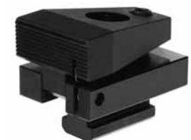
Durch Anziehen der Kugeldruckschraube wird das Werkstück gleichzeitig an Festanschläge und auf Auflagen niedergezogen. Das günstige Hebelverhältnis ermöglicht hohe horizontale Spannkkräfte. Mit Muttern für T-Nuten (DIN 508) auch in anderen Nutenmaßen einsetzbar.
