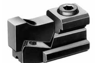
Keilspanner für flache Werkstücke. Um eine geringe Spannhöhe bei kleinen Nutentiefen zu erhalten, können die Spanner bis zum Maß >x< abgenommen werden.
