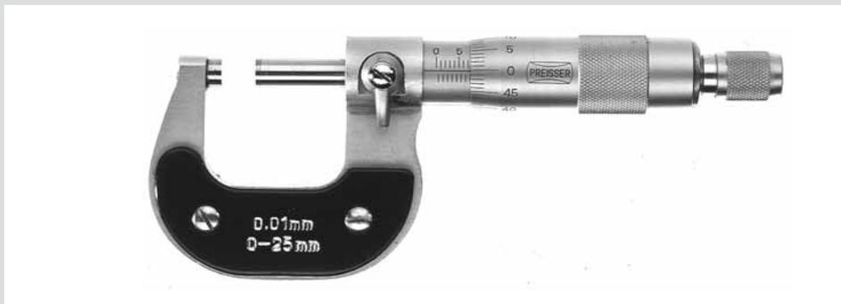
Bügel, Meßtrommel und Hülse sind mattverchromt. Bügel geschmiedet mit aufgeschraubten Isolierplatten. Mit Gefühlsratsche, sie ermöglicht einen gleichbleibenden Meßdruck, einjustiert auf 10N. Hebelfeststellung und nachstellbarer Mutter, Spindel gehärtet, Gewinde geschliffen 0,5 mm Steigung. Meßflächen sind mit Hartmetall bestückt. Ablesung 0,01 mm.
