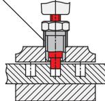
Klemmung gelöst und Spannschraube M8 vollständig herausgedreht. Raststift bleibt eingerastet. (Sicherheitsfunktion)
