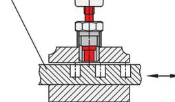
Spannschraube ist nicht mehr im Eingriff, der Raststift kann jetzt aus der Rastbohrung gezogen werden
