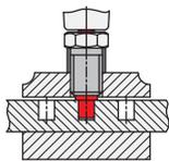
Verstellschiene durch Raststift positioniert, mit der Spannfläche des Raststiftes über den Rändelgriff und die Spannschraube M8 geklemmt.
