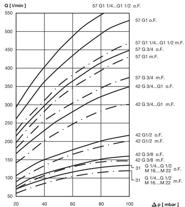
Luftdurchsatz [l/min] in Abhängigkeit von der Druckdifferenz  $\Delta p$  [mbar] Behälter/Außenraum mit Filter (40  $\mu$ m):      ·
