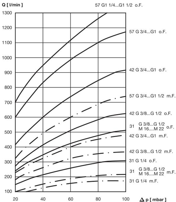
Luftdurchsatz [l/min] in Abhängigkeit von der Druckdifferenz  $\Delta p$  [mbar] Behälter/Außenraum mit Filter (40  $\mu$ m):      ·
