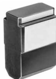
Zum Ausrichten von Vorrichtungen und Spannzeugen auf Maschinentischen mit T-Nuten nach DIN 650. Gegenüber den angeschraubten, überstehenden festen und flachen Nutensteinen haben Sie den Vorteil, daß die Maschinentische nicht beschädigt werden können, da sie erst nach dem groben Ausrichten seitlich eingeschoben werden.
