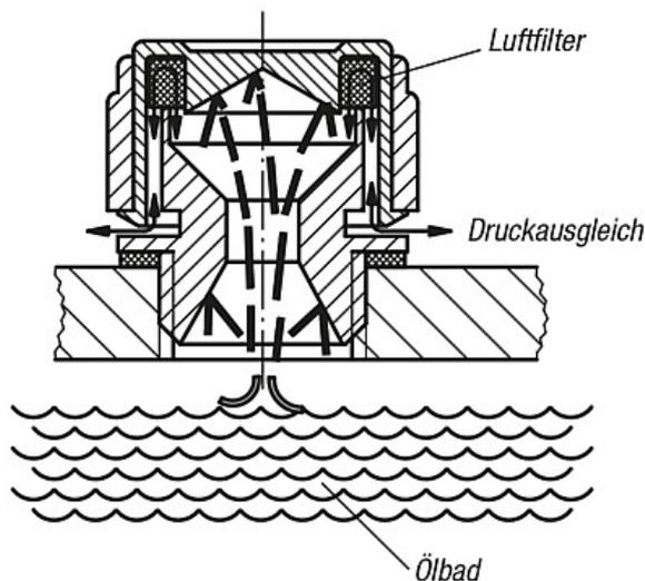
Bei einem im Ölbad laufenden Getriebe besteht die Gefahr, dass aufspritzendes Öl durch die Entlüftungsschraube austritt. Um dies zu verhindern, wurde diese mit einer Schikane (Spritzschutz) versehen. Durch die sich verjüngende Bohrung gelangt nur noch ein Teil eines Spritzstrahls. Dieser wird am Deckelboden so umgeleitet, dass ohne wesentliche Behinderung des Entlüftungsvorgangs das Öl zurückgeführt wird.
