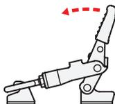
Hebelarm anheben, bis der Zuganker im Gegenhalter außer Eingriff ist.
