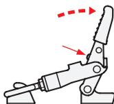
Der Zuganker kommt am Gegenhalter in Eingriff, wenn zum Spannvorgang der Entriegelungsknopf gedrückt wird.
