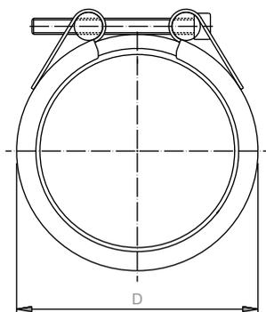
Flexible Rohrkupplungen für die Verbindung von Rohrleitungen
