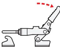
Durch Zurückbewegen des Hebelarmes wird der Zuganker angehoben und damit der Gegenhalter freigegeben (Einhandbedienung).
