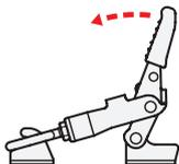
Zum **Spannen** den Hebelarm anheben, bis der Zuganker am Gegenhalter aufliegt.
