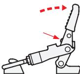
Der Zuganker kommt am Gegenhalter in Eingriff, wenn zum Spannvorgang der Entriegelungsknopf gedrückt wird.
