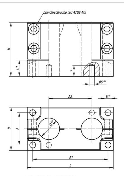
Lagetoleranz Passbohrungen: ±0,01 Lagetoleranz Bohrungen: ±0,1
