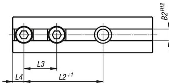
Beim Aufbau mehrerer Höhenadapter sind die Befestigungsschrauben ISO 10642 bzw. DIN 7984 durch um das Maß H verlängerte Schrauben zu ersetzen.
