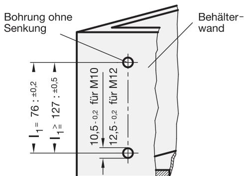
Die Montage der Ölstandsanzeiger GN 654 / GN 654.1 ist sehr einfach und wirtschaftlich. Es genügen 2 Bohrungen  $\varnothing 10,5$  bzw.  $\varnothing 12,5$  mm im Abstand  $l_1$  in der Behälterwand. Die Ölstandsanzeiger können auch direkt d. h. ohne Mutter montiert werden, wenn die Behälterwand mit dem betreffenden Gewinde versehen wird.
