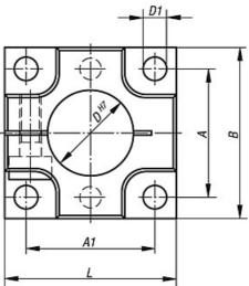
Lagetoleranz Passbohrungen: ±0,01 Lagetoleranz Bohrungen: ±0,1
