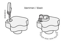
**Mit** eingestecktem Schlüssel (Drehen ist nicht erforderlich) ist die normale Funktion eines Sterngriffes (klemmen / lösen) gegeben.
