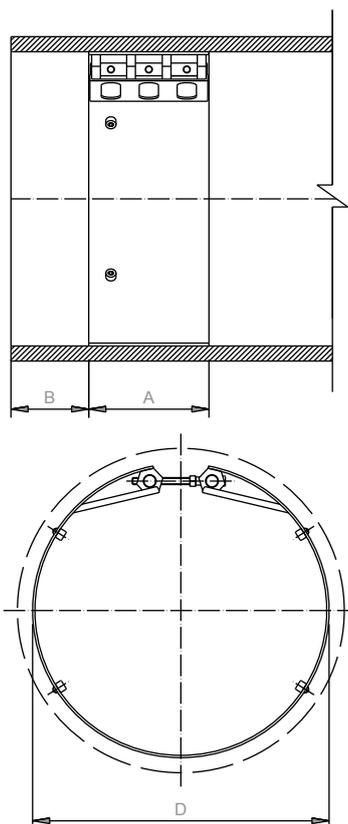
Flexible Rohrkupplungen mit axialer Verankerung für die Verbindung von Rohrleitungen
