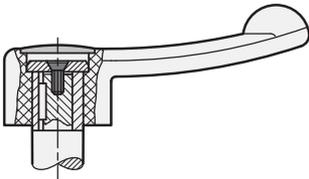
Schaltgriff GN 623 / GN 623.5 befestigt mit Nabennut / Passfeder unter Verwendung von Vorlegescheiben GN 184 / GN 184.5 → Seite 978.
