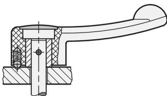
Schaltgriff GN 623 / GN 623.5 mit Kugelraste zur Indexierung des Schaltwinkels, befestigt mit Querstift. Der Querstift ist unter einem Winkel von 45° zur Schaltachse anzubringen.
