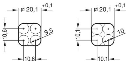
Desweiteren kann die Montagebohrung durch Bohren / Fräsen gemäß den nebenstehenden Skizzen realisiert werden.
