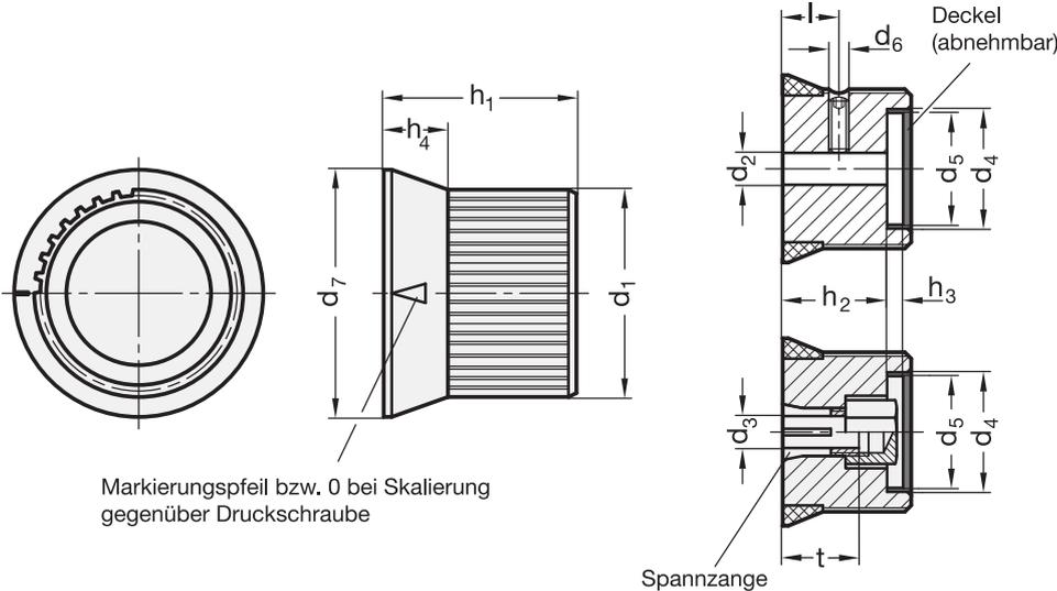
Markierungspfeil bzw. 0 bei Skalierung gegenüber Druckschraube
