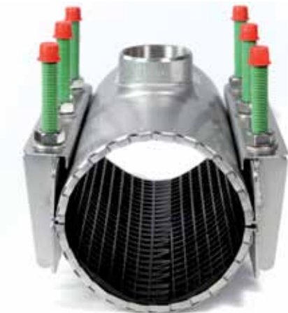
Hochdruckschelle bis 25 bar. Abkantung verhindert Verschiebung der Gummidichtung unter starkem Druck
