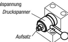
Wenn Sie auf den Spannzylinder einen Aufsatz montieren, sichern Sie den Schaft mit einem Schraubenschlüssel, damit er keine Drehkraft aufnimmt.
