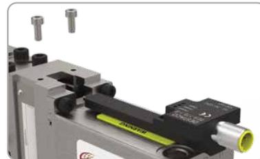
Abdeckung/Sensor abnehmen und Spannmechanismus freilegen, um den Öffnungswinkel einzustellen.
