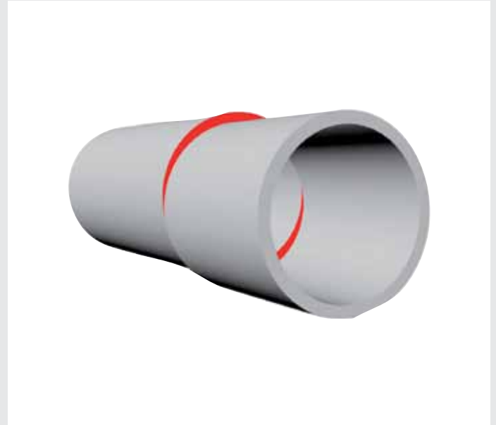
Verbindung von Rohren mit Achsversatz
