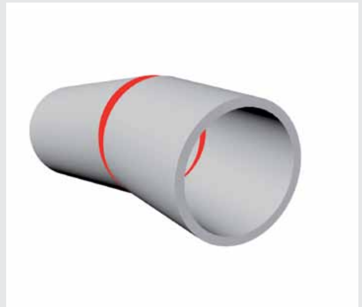
Verbindung von Rohren mit Auswinkelung
