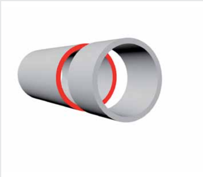
Verbindung von Rohren mit Rohr-endenabstand
