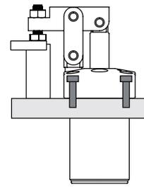
Montage mit Verschraubungskörper in einer Gewindebohrung und Verriegelung mit einer Kontermutter.
