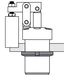
Montage mit Einführkörper in einer Bohrung ohne Gewinde und Verriegelung mit zwei Kontermuttern.
