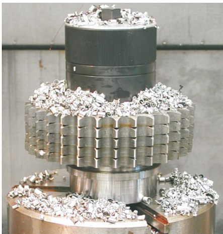
Kraftspannmutter zur Klemmung von Kettenrädern bei der Fräsbearbeitung
