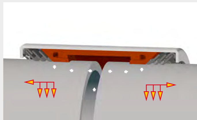
FIX-U Система с висока якост на опън с три обтегателни пръстена
