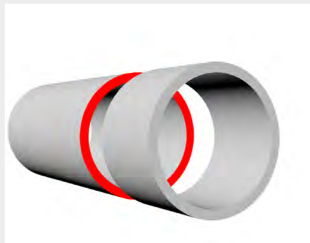
Свързване на тръби с отстояние между краищата
