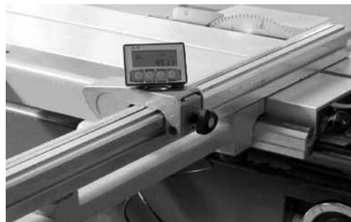
Anwendungsbeispiel: auf Kreissägemaschinen, Winkelschnitt
