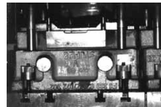
Kraftspannmutter zur Klemmung des Tischwerkzeuges einer Mehrstufenpresse
