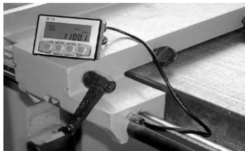
Anwendungsbeispiel: auf Kreissägemaschinen, Parallelschnitte
