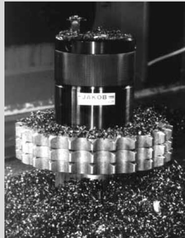
Kraftspannmutter zur Klemmung von Kettenrädern bei der Fräsbearbeitung
