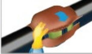
**DENSO® Petrolatum-Band** mittig auf den Flansch auflegen und über den äußeren Umfang, Schraubenköpfe, Muttern usw. formen. Bandbreite in Abhängigkeit von der Nennweite: 250, 300 oder 400 mm.
