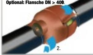
Mit 2 Lagen **DENSO® Petrolatum-Band** abwechselnd am rechten und linken Flanschrand ansetzen. Die Länge der **DENSO® Petrolatum-Band**-Zuschnitte entsprechen dem äußeren Flanschumfang zzgl. 50 mm Überlappung. Die an beiden Seiten des Flansches angrenzende Rohroberfläche mit **DENSO® Petrolatum-Band** manschetten- oder wendelartig umhüllen.
