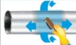
Die Oberfläche muss frei von Staub und losen Anhaftungen sein. Rost muss mit einer Drahtbürste entfernt werden. Reinheitsgrad (ISO 8501-1) mind. St2.
