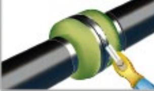
Spalt zwischen den Flanschtellern hohlraumfrei, abhängig von der Betriebstemperatur mit **DENSO®-Jet** oder **DENSO®-Fill** verfüllen.
