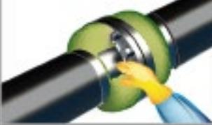
**DENSO® Petrolatum-Massen** mit der Hand oder Spachtel zur Hohlraumverfüllung auftragen. Masse anformen und mit **DENSO® Petrolatum-Band** anschließend vollständig wickeln.
