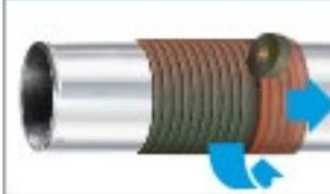
**DENSO® Petrolatum-Band** mit geforderter Überlappung spiralförmig und faltenfrei um das Rohr wickeln. Anschließend **DENSO® Petrolatum-Band** mit der Hand verstreichen und fest andrücken.
