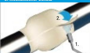
Mit **DENSO® Petrolatum-Band** umhüllte Bereiche mit einer Lage **DEPROTEC®-DRM PP** bis auf die werksumhüllte Oberfläche verkleiden. Rohrschutzmatte im Überlappungsbereich durch Anflämmen und sofortiges Andrücken fixieren. Als erweiterter mech. Schutz kann **DEPROTEC®-PUR** Glasfaserbinde verwendet werden.
