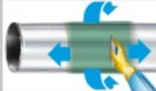
**DENSO® Primer** auf der Oberfläche gründlich einarbeiten. **DENSO® Primer** mit der Hand oder dem Spachtel satt deckend auf die zu umhüllende Oberfläche auftragen.
