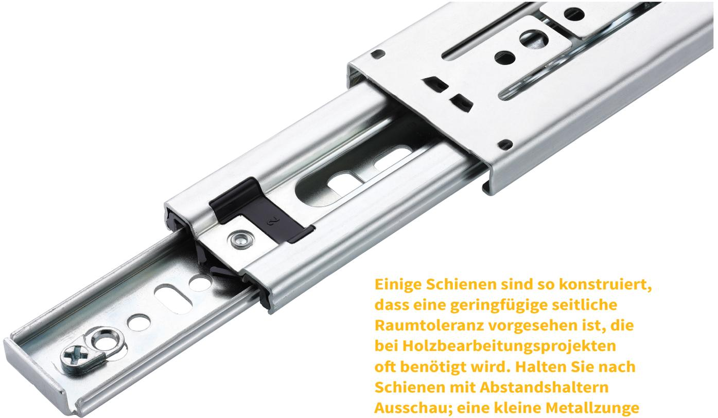
Einige Schienen sind so konstruiert, dass eine geringfügige seitliche Raumtoleranz vorgesehen ist, die bei Holzbearbeitungsprojekten oft benötigt wird. Halten Sie nach Schienen mit Abstandshaltern Ausschau; eine kleine Metallzunge mit einem sie umgebenden U-Schlitz. Dadurch kann die Spitze der Zunge ein wenig gebogen werden, um problematische Toleranzen besser auszugleichen.
