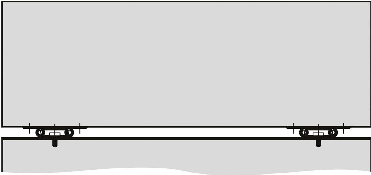
**Die DA0115RC besitzt Kugelumlaufwagen** und ist somit ideal für die Flachmontage geeignet (die genauen Lastwerte entnehmen Sie bitte dem Datenblatt).
