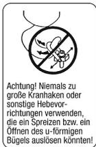
Achtung! Niemals zu große Kranhaken oder sonstige Hebevorrichtungen verwenden, die ein Spreizen bzw. ein Öffnen des u-förmigen Bügels auslösen könnten!
