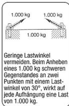
Geringe Lastwinkel vermeiden. Beim Anheben eines 1.000 kg schweren Gegenstandes an zwei Punkten mit einem Lastwinkel von 30°, wirkt auf jede Aufhängung eine Last von 1.000 kg.
