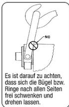
Es ist darauf zu achten, dass sich die Bügel bzw. Ringe nach allen Seiten frei schwenken und drehen lassen.
