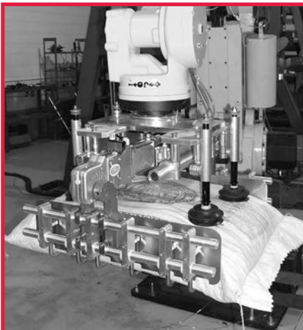
Flexibles und modulares Konzept zum Anheben von Säcken.
